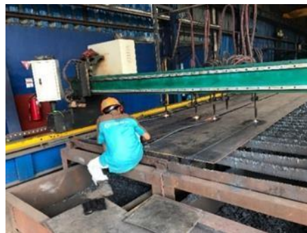
Pemotongan Plate Dengan CNC Cutting (Sumber : PT Duta Hita Jaya(Setu))
