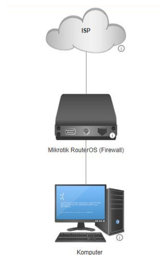
Gambar 2. Topologi Sebelum Instalasi Sophos
